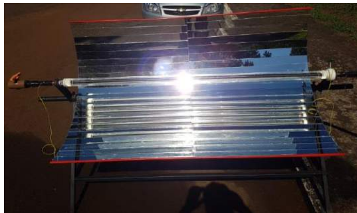
Figura 1 – Protótipo do concentrador cilíndrico parabólico de foco linear.
