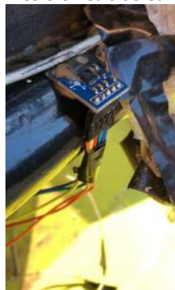
Figura 2 Fixação do Acelerômetro ao banco das empilhadeiras
