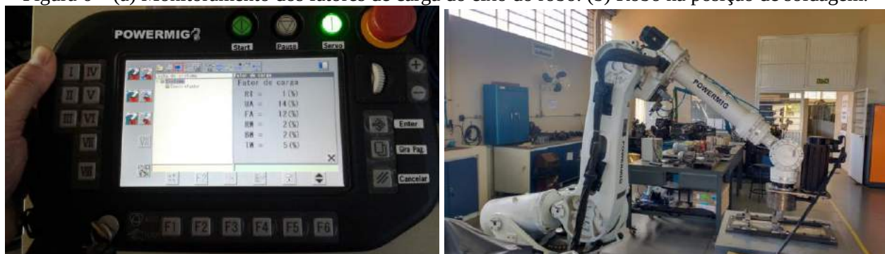
Figura 6 – (a) Monitoramento dos fatores de carga do eixo do robô. (b) Robô na posição de soldagem.
