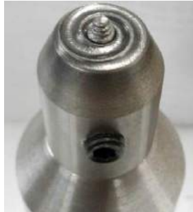
Figura 5 – Ferramenta de soldagem.
