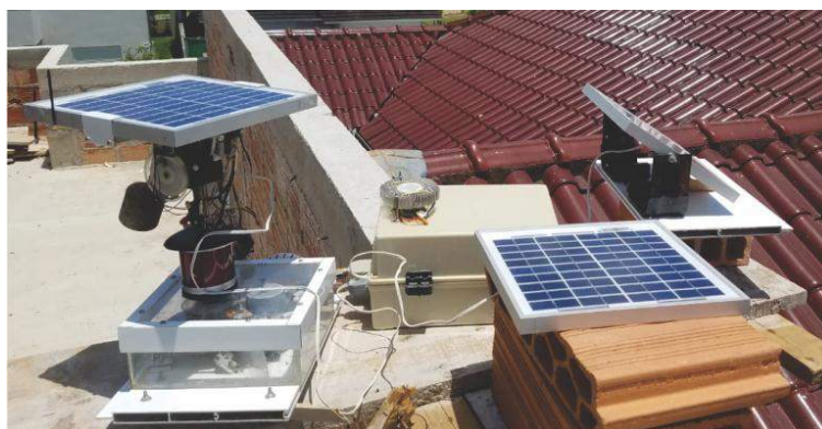
Figura 7 – Módulos nos sistemas horizontal, inclinado e com seguidor solar
