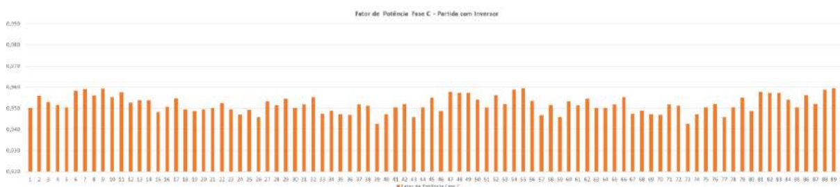
Figura 7 - Fator de potência Fase C acionamento com inversor de frequência.
