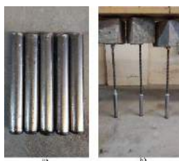
Figura 3 - a) Tubos metálicos utilizados para a proteção da ponta da barra de BFRP; b) Corpos de prova acomodados em um gabarito de madeira para centralização das barras de BFRP.
