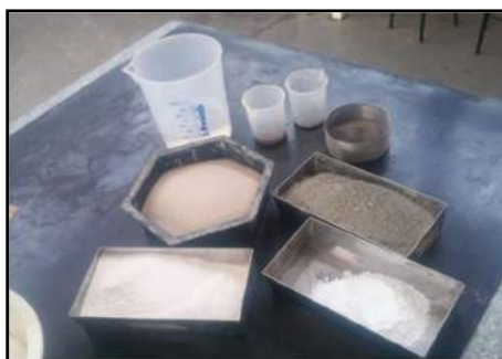
Figura 1 – Materiais utilizados para produção de argamassa autonivelante
