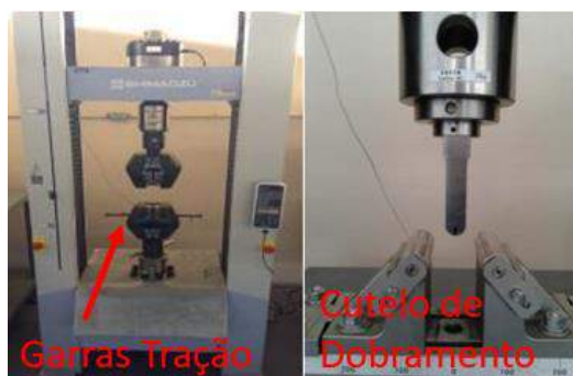
Figura 7 – Máquina universal de ensaios Shimadzu com garras de tração e cutelo de dobramento
