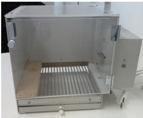
Figura 1: Aparato de Esquiva Inibitória
