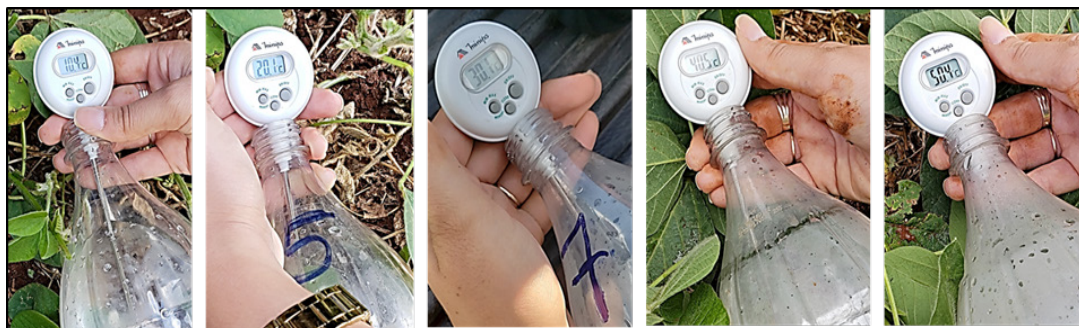
Figura 2 - Aferição da temperatura da água antes da preparação da calda com mancozebe WG (Unizeb Gold®)
