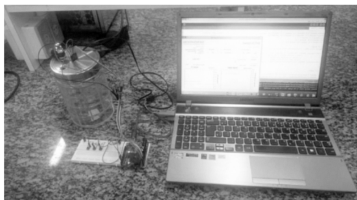
Figura 3 - Vista do protótipo do sistema de Nariz Eletrônico constituído pela câmara de gás, arranjo de sensores, microcontrolador e computador
