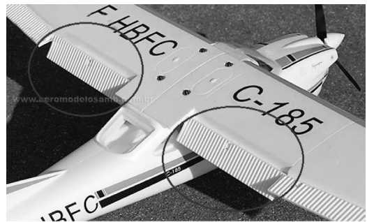
Figura 7 - Flaps em um avião de pequeno porte.
