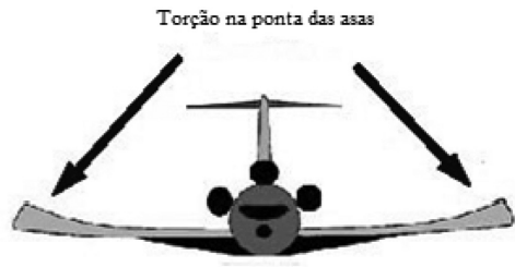
Figura 5 - Torção geométrica em uma asa.
