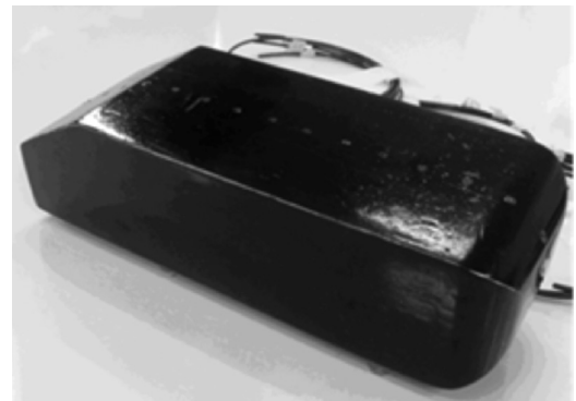
Figura 3 - Primeiro modelo construído em escala 1:4 do corpo de Ahmed
