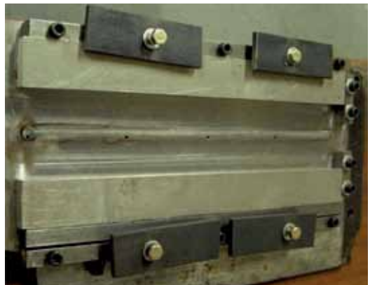
Figura 7 - Sistema de fixação das chapas a serem soldadas.
