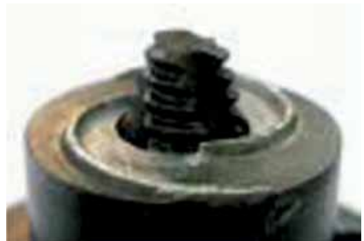
Figura 3 - Ferramenta de ombro plano com estrias em espiral (AIRES, 2007).
