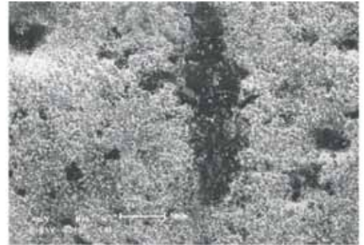
Figura 9 - Imagem obtida no MEV para a amostra nitretada após ensaio de corrosão.
