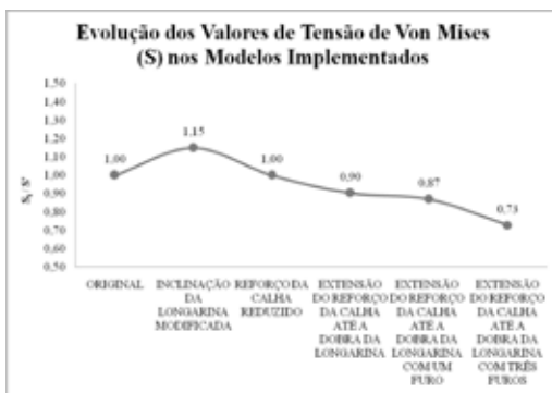
Figura 16 - Evolução dos valores de tensão de Von Mises (S) nos modelos implementados, onde S 0 é a tensão no modelo original e S i a tensão nos modelos propostos seguintes.
