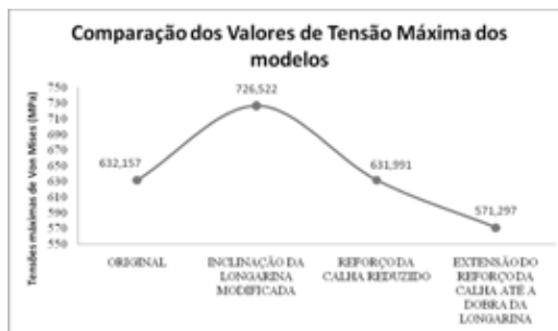
Figura 13 - Tensões máximas da estrutura original e dos modelos com alterações geométricas.
