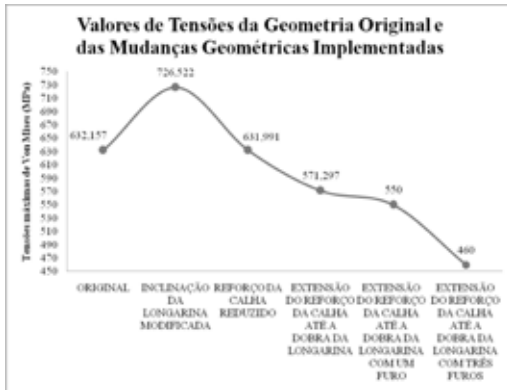
Figura 15 - Tensões máximas das regiões críticas em todos os modelos, mostrando a redução de tensões.
