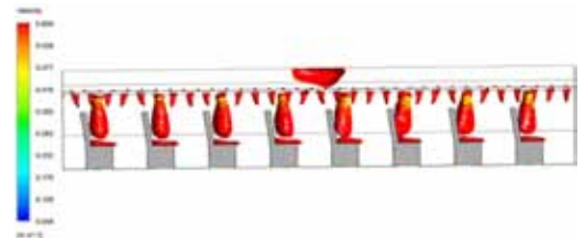
Figura 8 - Perfil de velocidade incidente sobre a região de acomodação dos passageiros – Fluxo com velocidade de 0,6 m/s.
