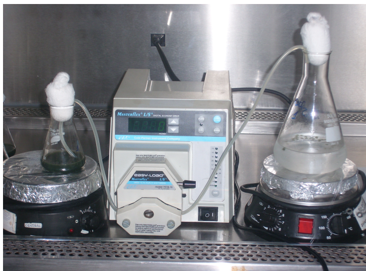
Figura 3.1 Aparato experimental utilizado para imobilização do microrganismo.
