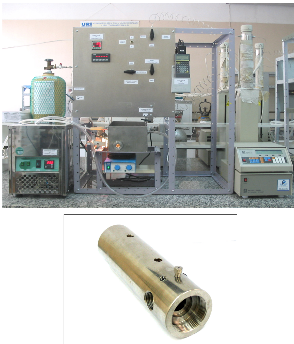
Figura 3.5 – Fotos da unidade experimental utilizada para avaliação da atividade de hidrólise de lipases ressuspensas em propano pressurizado.
