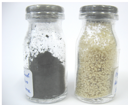
Figura 4.6. Foto da enzima imobilizada com Accurel EP100 (direita) e Carvão Ativo (esquerda).
