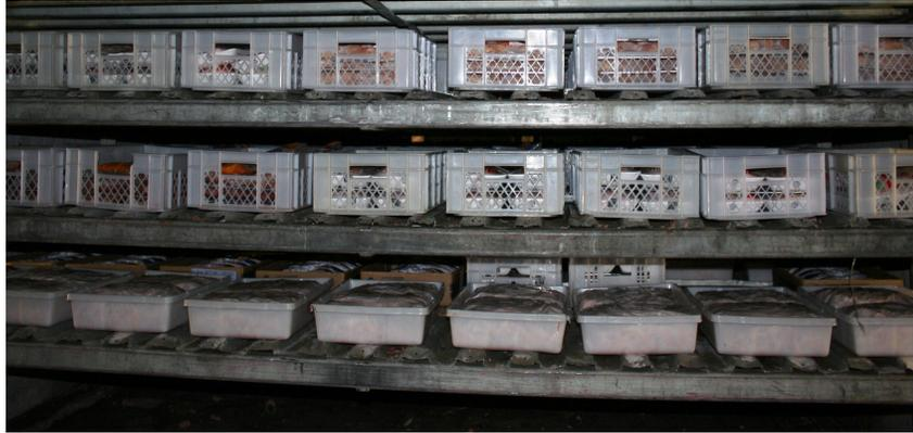
**Figura 3.3.** Túnel de Congelamento a  $-45^{\circ}\text{C}$ .
