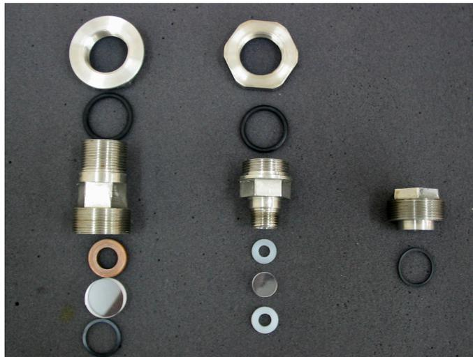
Figura 3.4 - Detalhe das conexões de fechamento da célula com respectivos anéis de vedação e janelas de safira.
