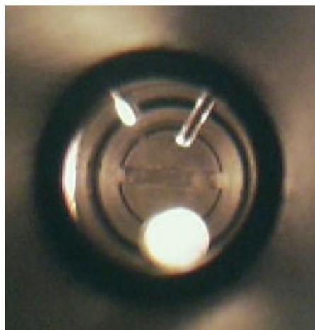
Figura 3.8 - Detalhe da célula indicando o posicionamento do termopar.
