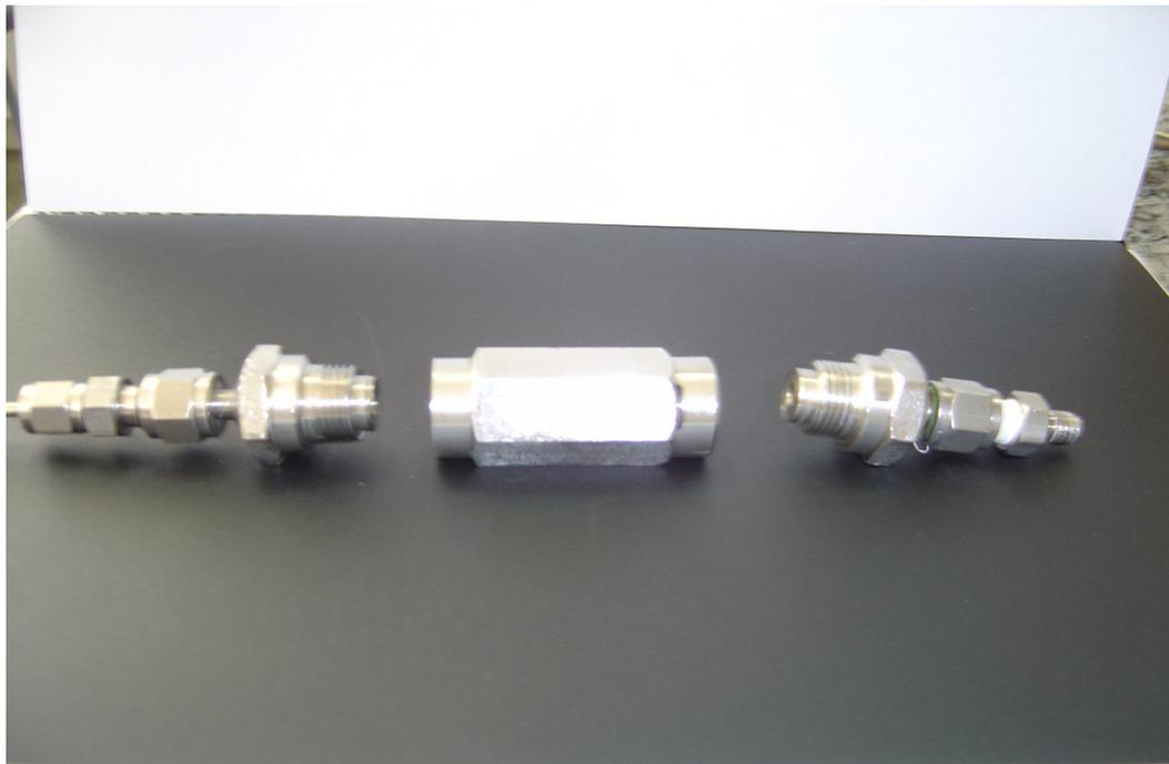
Figura 36. Vista lateral das peças que compõem a coluna de fracionamento.
