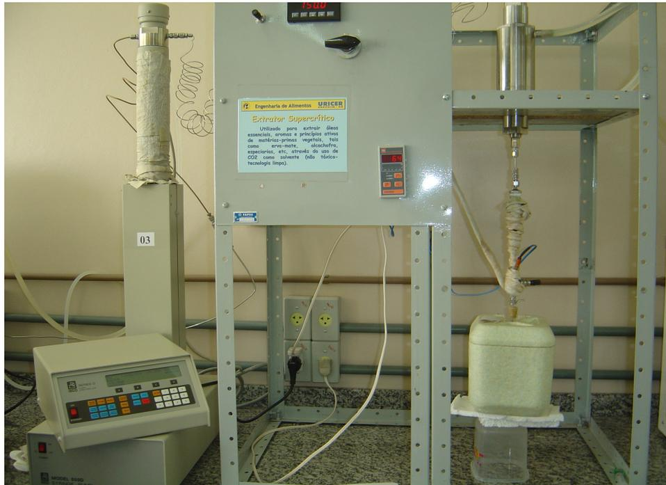
Figura 32. Fotografia da unidade experimental de bancada para o processo de extração e concentração de óleos essenciais.
