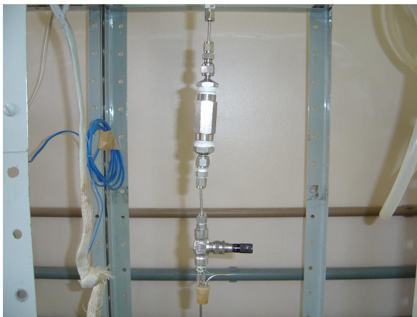
Figura 34. Fotografia da coluna de fracionamento acoplada ao extrator.
