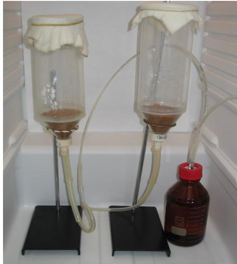
Figura 3.2: Biorreatores utilizados no processo fermentativo
