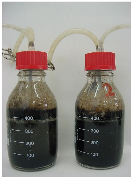
Figura 2. Reatores utilizados para aclimatação do lodo anaeróbio
