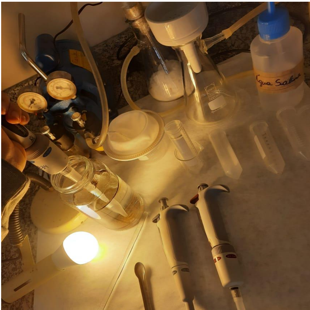
Figura 3 - Armadilha luminosa para coleta dos náuplios de A. salina .
