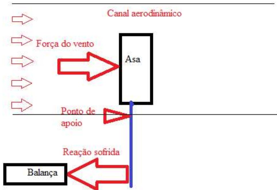
Figura 3 - Esquema de funcionamento da balança.
