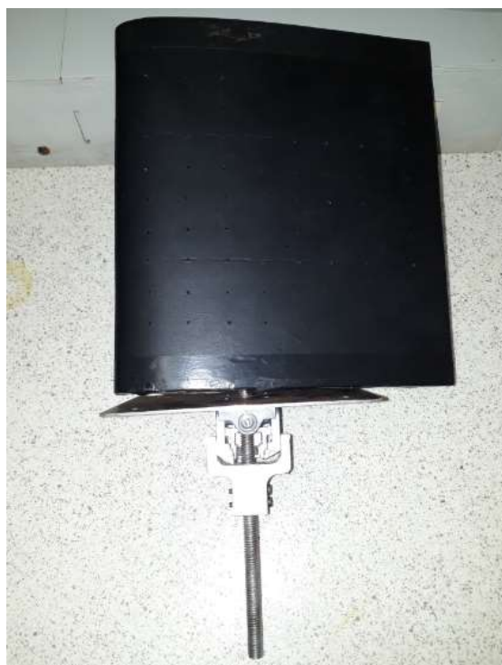
Figura 9 - Asa presa ao sistema de cruzeta.
