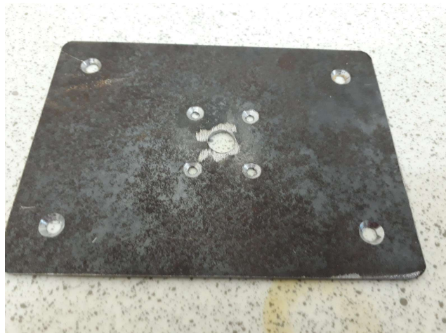
Figura 6 - Placa metálica para prender a cruzeta no MDF.
