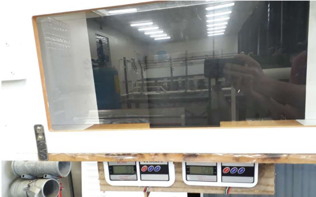
Figura 11 - Sistema montado no canal aerodinâmico.
