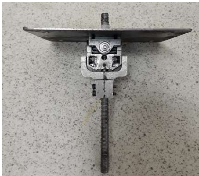
Figura 7 - Cruzeta presa ao eixo de transferência e chapa metálica.
