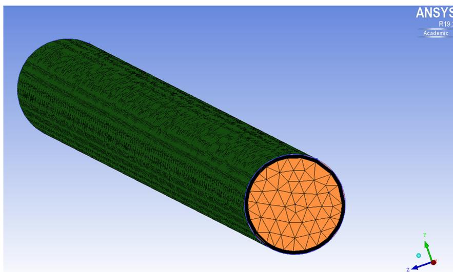
Figura 3.7 – Malha tetraédrica com prismas.
