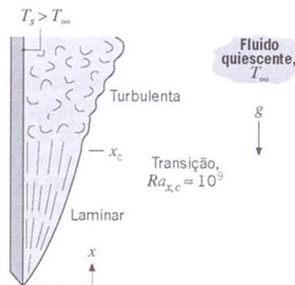
FIGURA 9.5 Transição na camada-limite de convecção natural em uma placa vertical.
