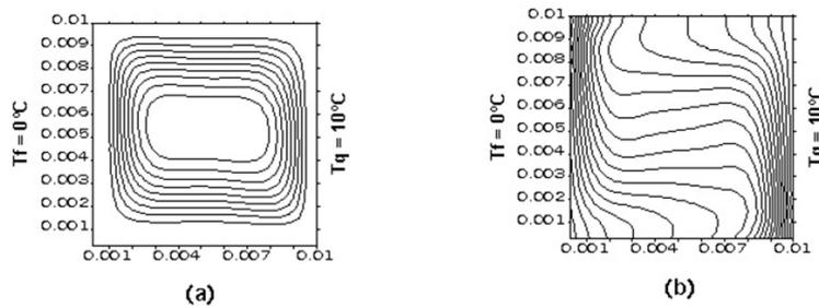
Figura C.1 – Problema clássico de convecção natural em uma cavidade quadrada: (a) Função de corrente, (b) Isotermas.
