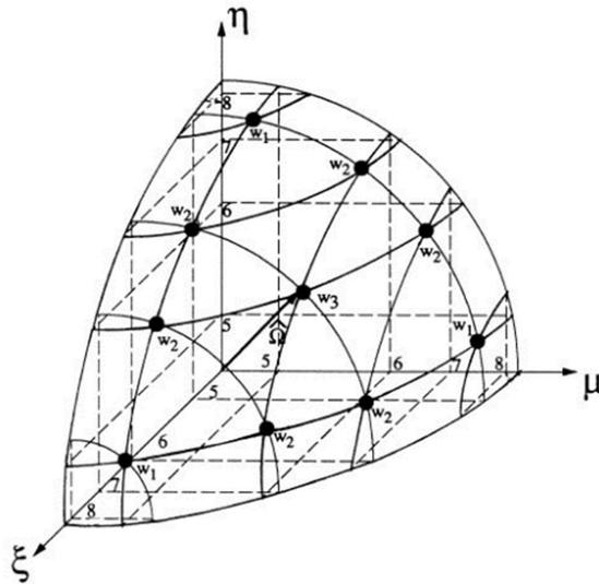
12.10 – Volume finito submetido a um fluxo de calor radiativo.
