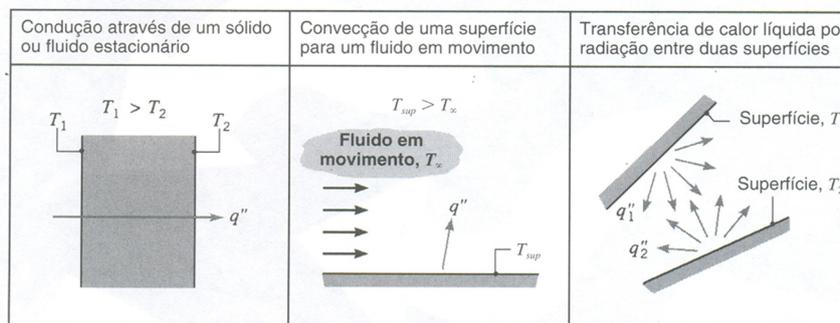
FIG. 1.1 Modos de transferência de calor: condução, convecção e radiação.
