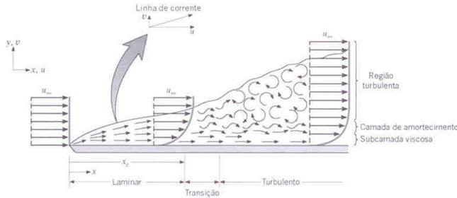
FIGURA 6.6 Desenvolvimento da camada-limite de velocidade sobre uma placa plana.
