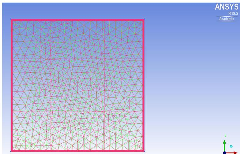
Figura 3.3 –Malha tetraédrica com prismas.
