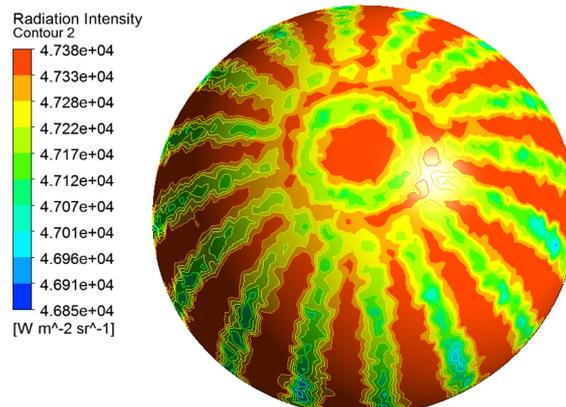
Figura 3.13 –Intensidade de radiação sobre a semiesfera.
