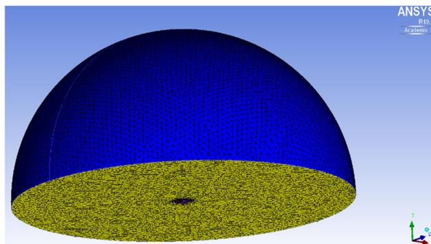
Figura 3.12 –Malha tetraédrica com prismas.
