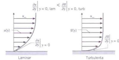
FIGURA 6.7 Comparação dos perfis de velocidades nas camadas-limite de velocidade laminar e turbulenta para a mesma velocidade na corrente livre.<sup>3</sup>
