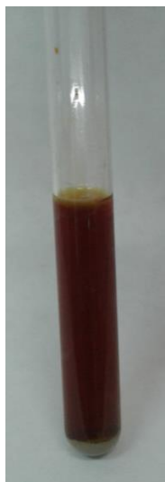
Figura 4.14 - Ensaio qualitativo para iodeto empregando solução de cobre II como reativo.
