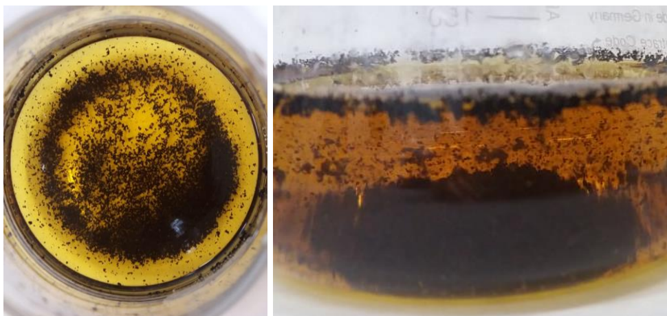
Figura 3.5 - Sistema reacional após ensaio de decomposição catalítica do peróxido de hidrogênio por íons iodeto, na presença de azul de metileno.
