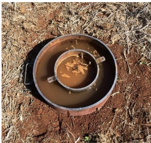
Figura 2- Metodologia dos anéis concêntricos para avaliação da infiltração de água no solo
