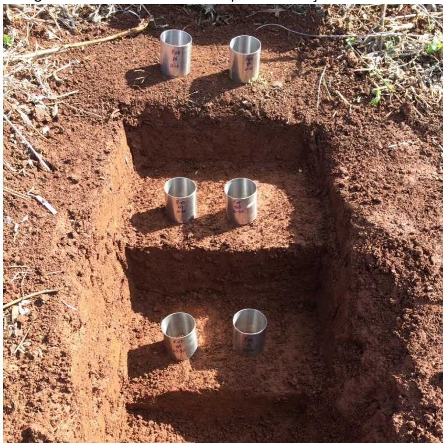
Figura 3 - Metodologia dos anéis volumétricos para avaliação da densidade do solo
