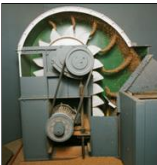
Figura 01- Elevador de canecas Fonte: Sulbelt, (2010)
