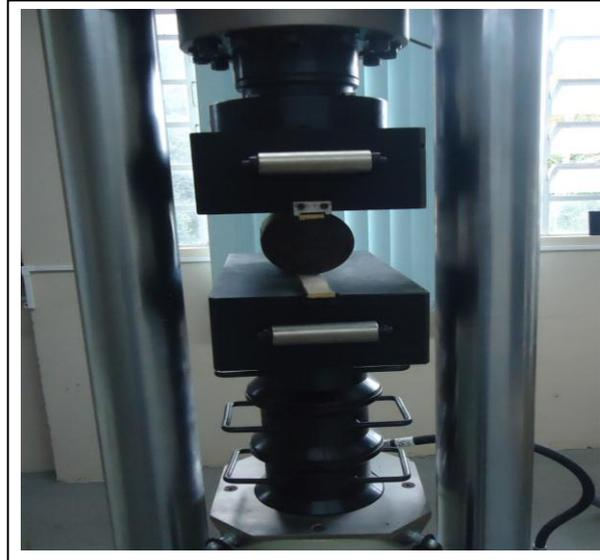
**Figura 8** - Corpo de prova durante a tração por compressão diametral
