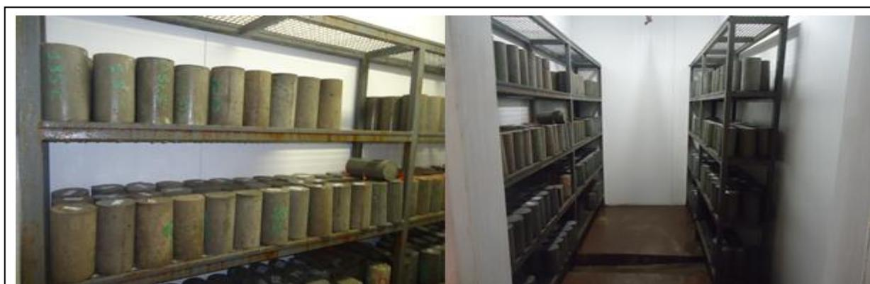
**Figura 5** - CP's desmoldados e dispostos em câmara úmida
