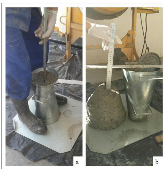
**Figura 6** - a) Execução do Slump test; b) Slump 100mm.
