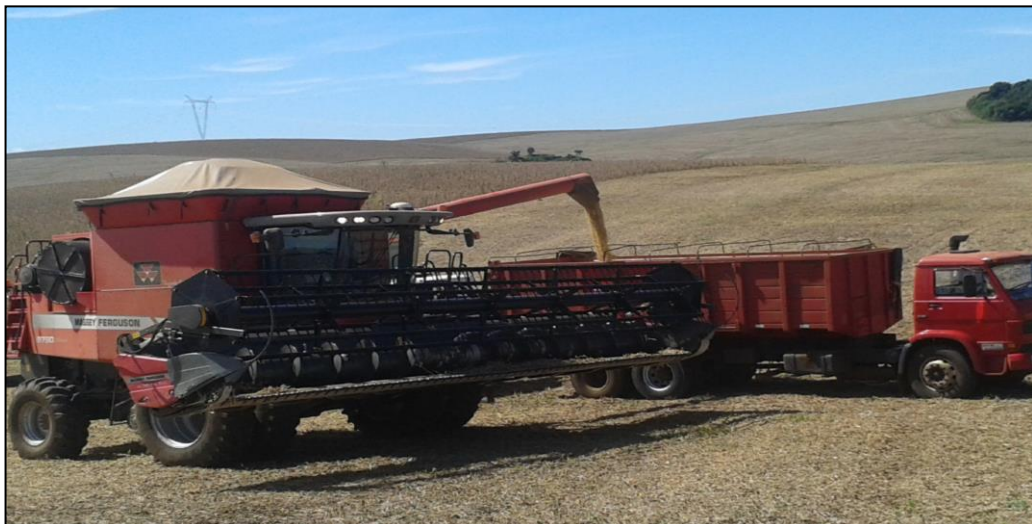
Figura 1. Máquina colhedora de Grãos equipada com sensor de produtividade.
