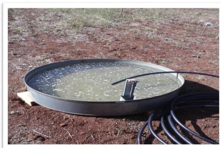
Os dados de evapotranspiração do tanque classe A foram coletados diariamente às 17:00 horas. As leituras foram realizadas através de um paquímetro manual que ficava preso a borda do poço tranquilizador. Devido a posição vertical do paquímetro, valor zero na posição superior e quinze na inferior, os valores das leituras eram ao contrário de uma régua graduada instalada normalmente de
