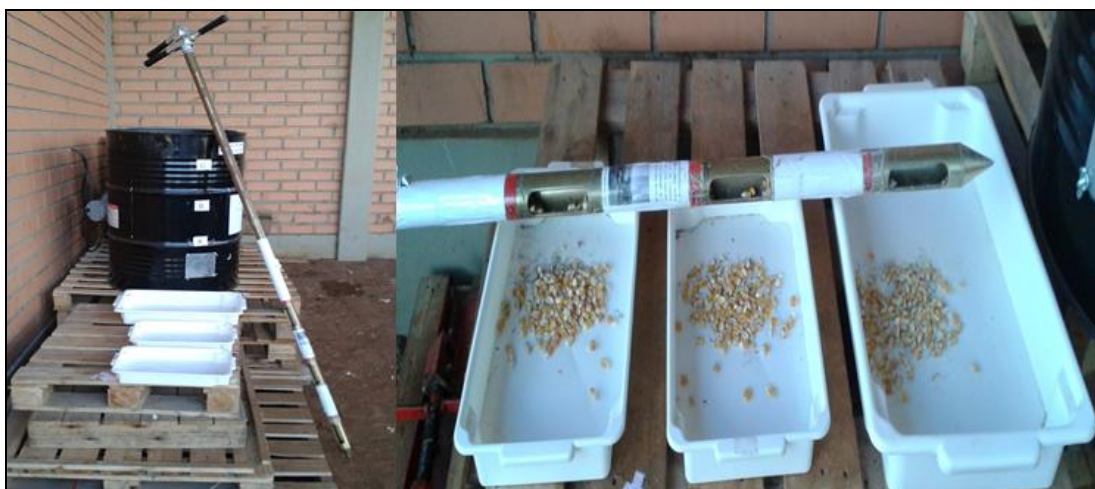
Figura 11- Material de coleta das amostras (1) Trado, (2) Bandejas, (3) Silo-Secador
