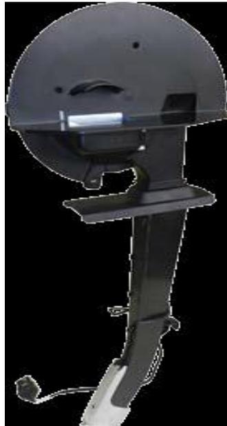
Figura 2. Tubo de sementes com sensor.
