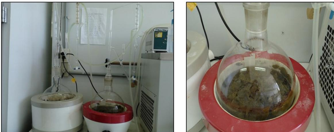
**Figura 2:** Hidrodestiladores utilizados para a extração do óleo essencial de *Eugenia uniflora*.
