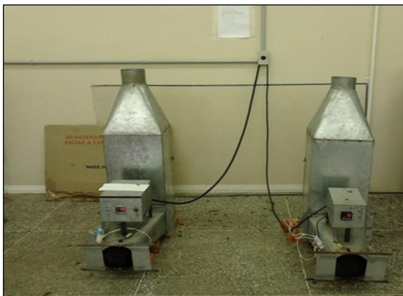
**Figura 1:** Secadores utilizados para a secagem das folhas de pitanga.
