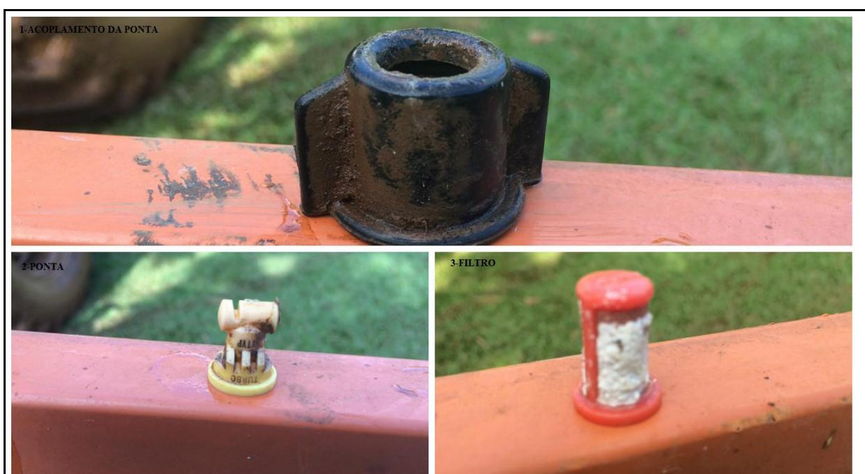
**Figura 9-** Conjunto de um bico de pulverização formado pelo acoplamento da ponta, filtro e ponta no momento de inspeção.
