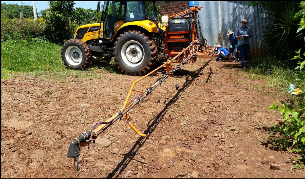
**Figura 4-** Pulverizador montado, com acoplamento aos três pontos do trator.
