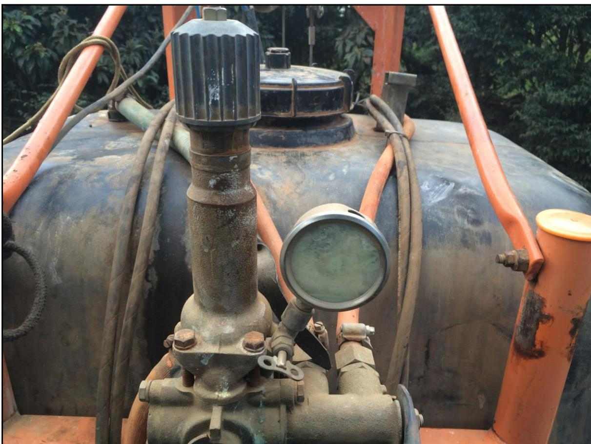
**Figura 6-** Manômetro de pressão de um pulverizador em mau estado de conservação.
