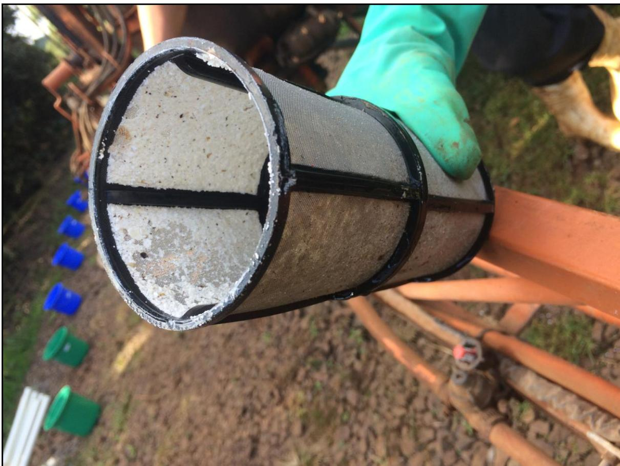
**Figura 7-** Malha do filtro principal do pulverizador apresentando grande quantidade de resíduos.
