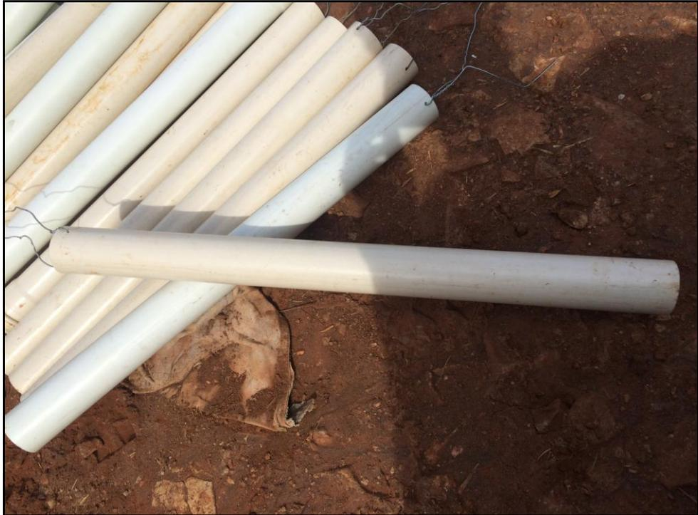
**Figura 2-** Canos de PVC utilizados em cada ponta para evitar a deriva e conduzir o líquido até o recipiente de coleta.
