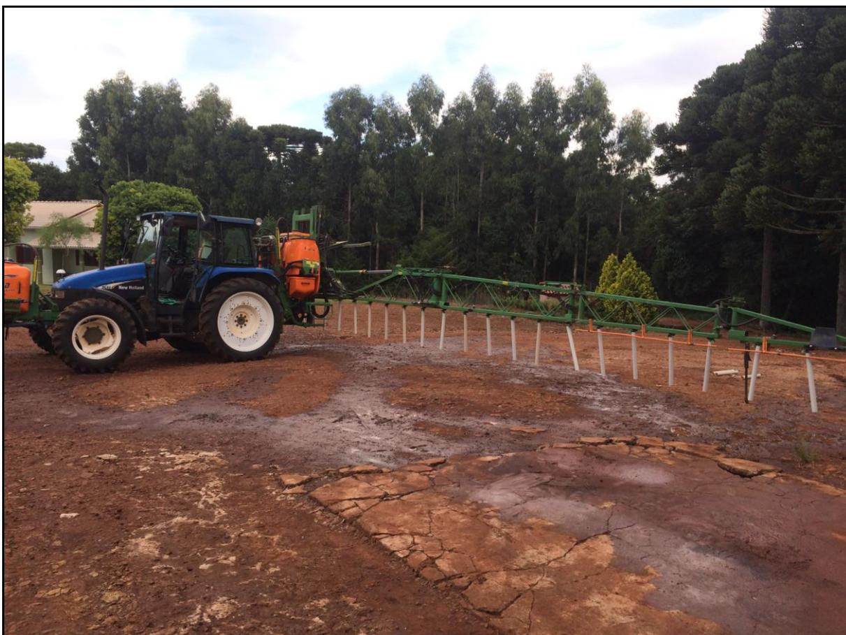
**Figura 8-** Pulverizador em funcionamento para identificar possíveis perdas de calda no sistema hidráulico.
