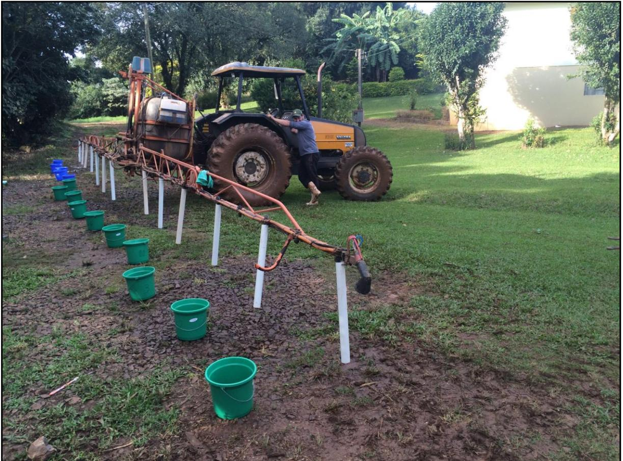
**Figura 10-** Coleta do volume de água distribuído por cada bico na barra de pulverização.
