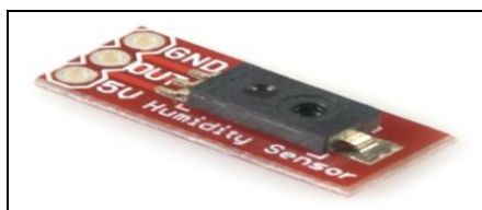
Figura 8 – Sensor de umidade HIH-4040
