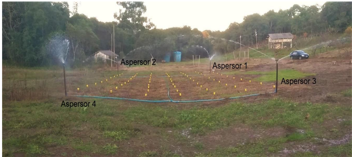
Figura 3 - Área com a malha de copos dentro da área de 4 aspersores com espaçamento de 12x18m na Estação Experimental de Irrigação Por Aspersão Convencional do Departamento de Ciências Agrárias.
