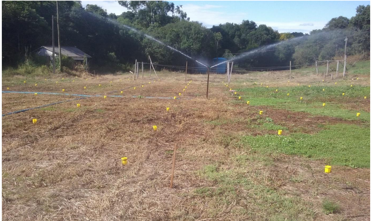
Figura 5 - Área com a malha de copos ao redor do aspersor com espaçamento de 12x18m na Estação Experimental de Irrigação Por Aspersão Convencional do Departamento de Ciências Agrárias.
