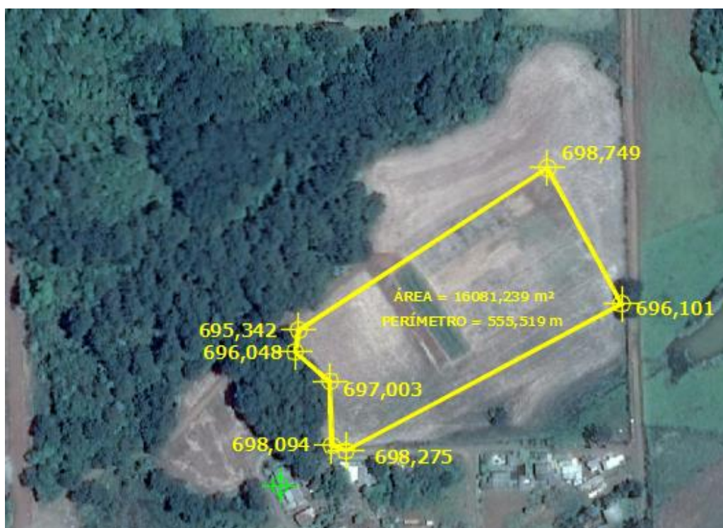
Figura 5 - Levantamento topográfico da área do experimento
