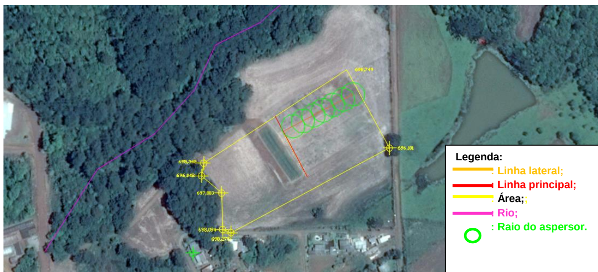
Figura 7 - Croqui do projeto para irrigação por aspersão convencional móvel
