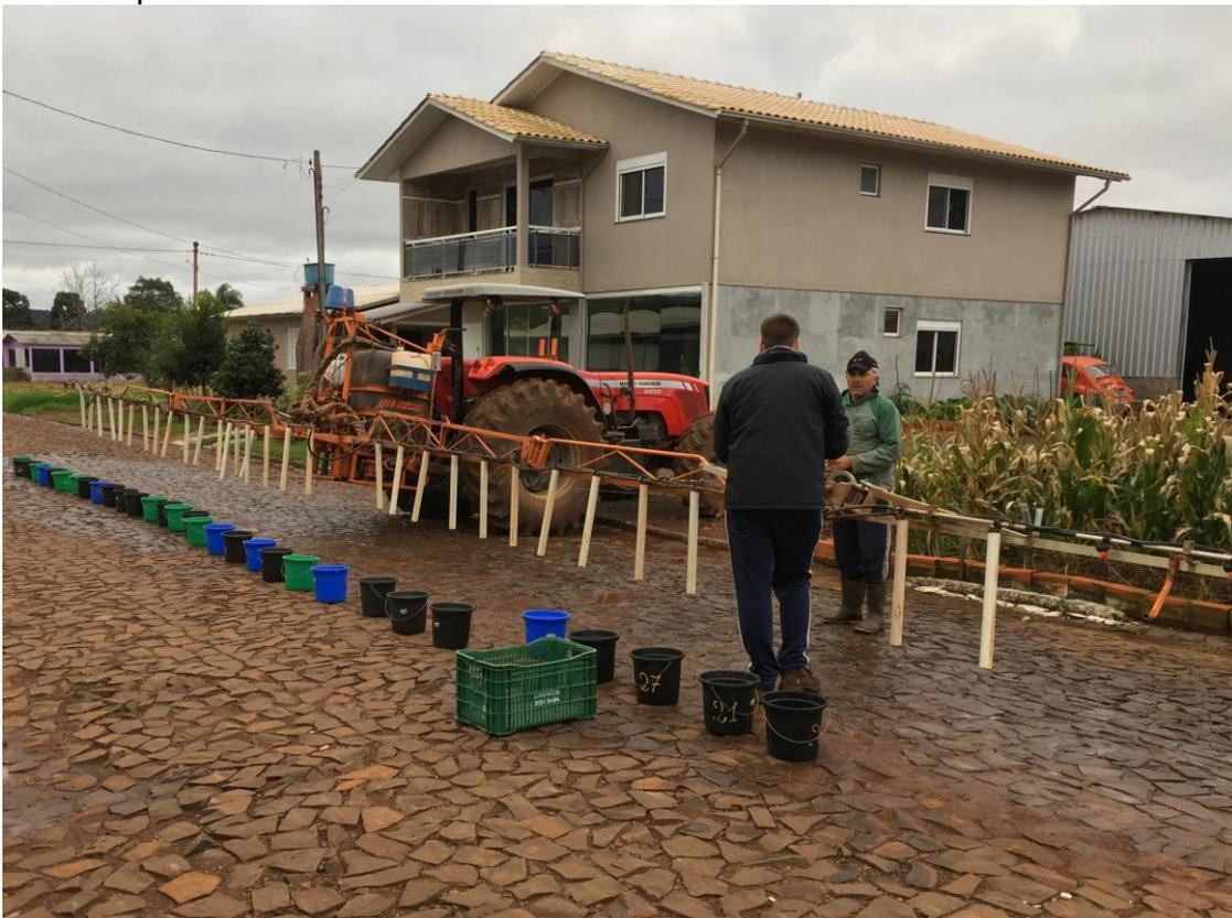
Foi ainda detectada uma variação entre as doses obtidas nas pontas de pulverização da barra do pulverizador com CV= 5,1 %, sendo a maior dose coletada de 117 L ha<sup>-1</sup> localizada na ponta de número 17 (Gráfico 1), e a menor dose observada,
