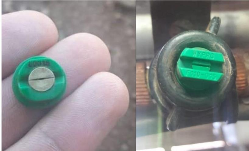
Ao iniciar os testes verificou-se que o equipamento estava em bom estado de conservação, sem vazamentos, sem resíduos nas partes internas e externas, porém o jato produzido pela ponta não estava de forma correta. Mesmo com resultados positivos para os índices de limpeza, foi realizada uma nova limpeza nos bicos, ponteiras e filtro do equipamento. A figura que representa o equipamento encontra-se a seguir (Figura 14).
