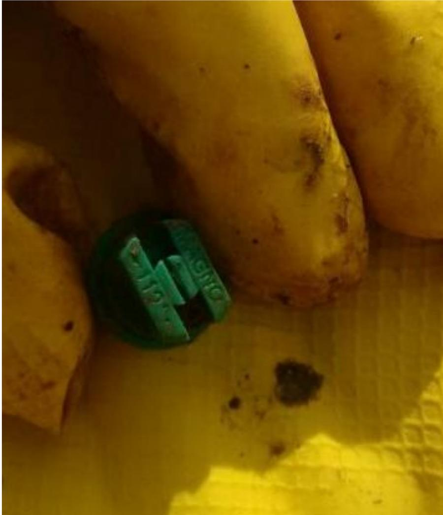
Figura 12 - Filtros de linha e dos bicos, ponta e tampa do filtro com alto índice de resíduo depositado em suas paredes.
