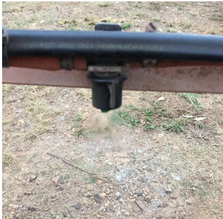
Após uma limpeza das partes citadas deu-se a continuação da avaliação obtendo como dose média de calda coletada de  $100,1 \text{ L ha}^{-1}$  (Gráfico 6), sendo esta diferente da dose pretendia pelo produtor de  $100 \text{ L ha}^{-1}$ , o que representa uma diferença de  $0,1 \%$  em relação à dose desejada. No entanto o erro atrelado ao volume pulverizado é bastante baixo.
