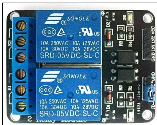
Figura 10 – Placa com dois relés utilizados para controlar a bomba d'água e o cooler.
