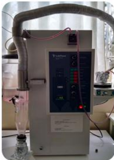
Figura 10 – Sistema de aspersão: Spray Drier
