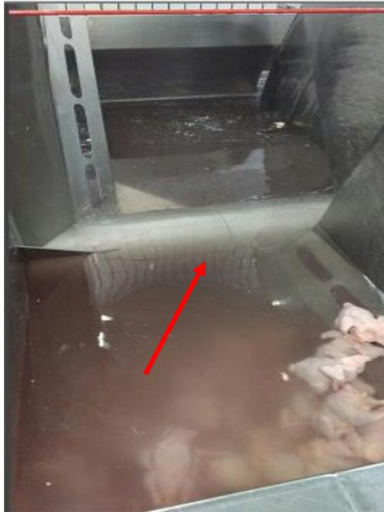
Figura 24: Redução do nível da água do pré-chiller e chillers na altura do eixo.
