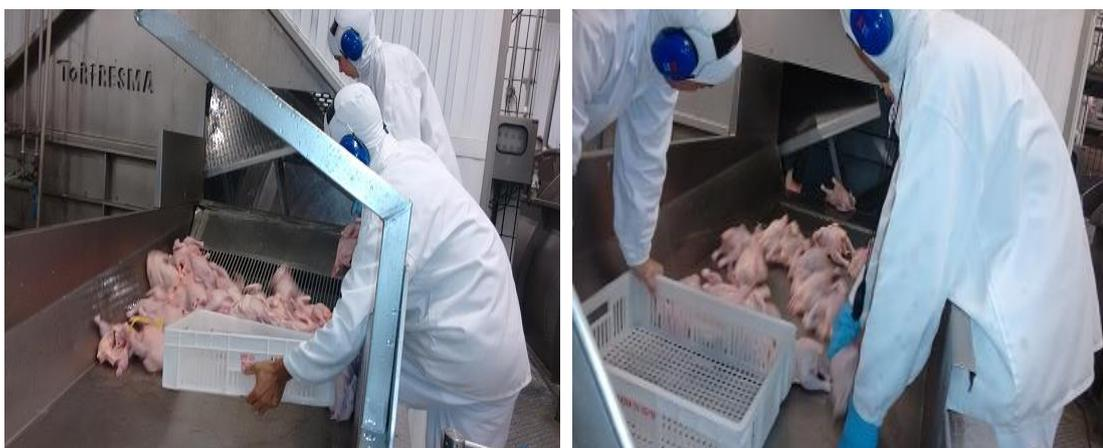
Figura 13: Fotos ilustrativas das carcaças sendo recoletadas na saída do pré-*chiller*.
