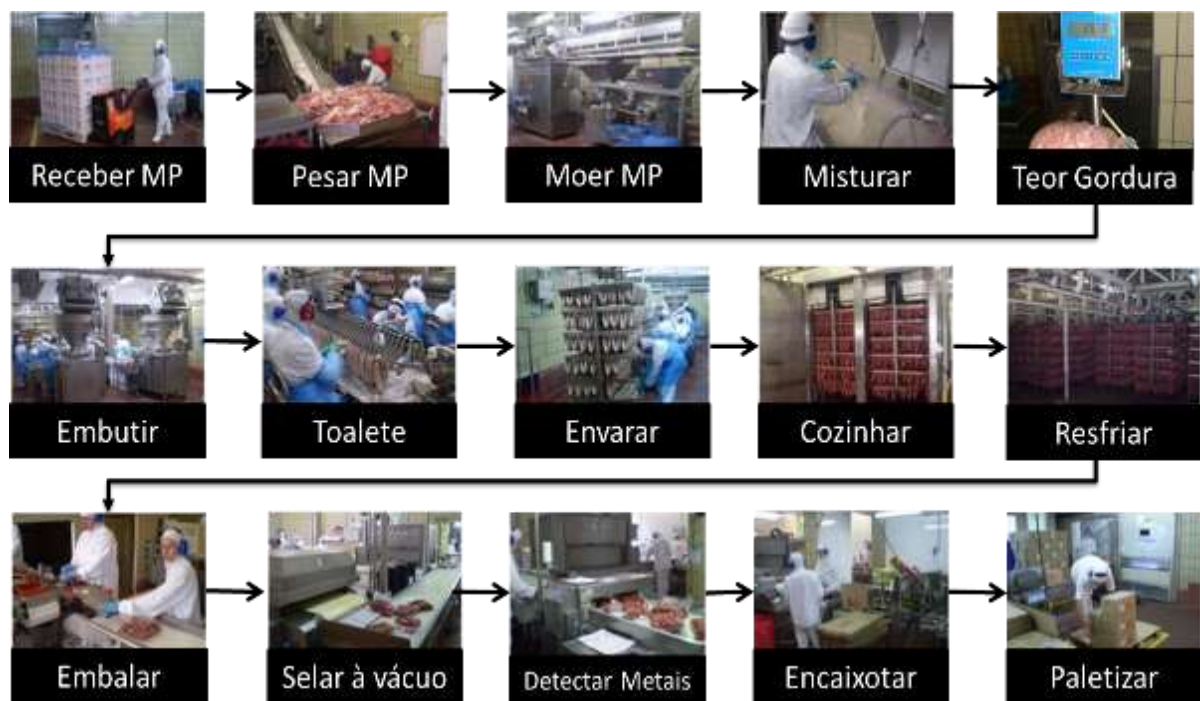
Figura 1. Fluxograma de produção de linguiça tipo calabresa
