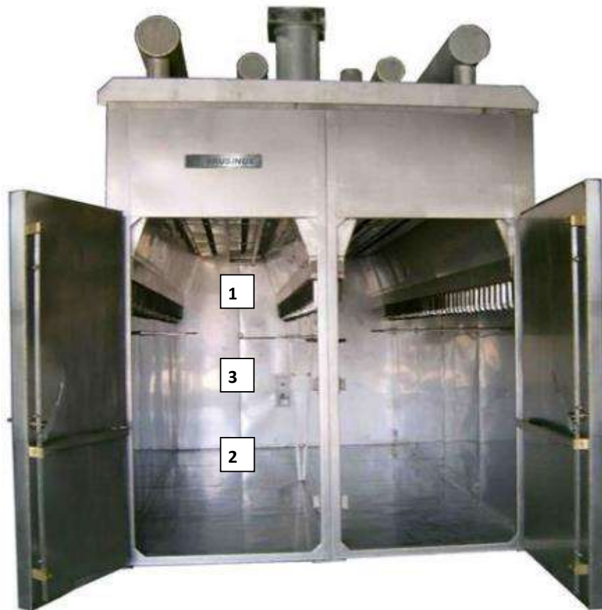
Figura 6. Diagrama esquemático das medidas de temperatura na parte superior, inferior e centro do produto nas estufas de cozimento.
