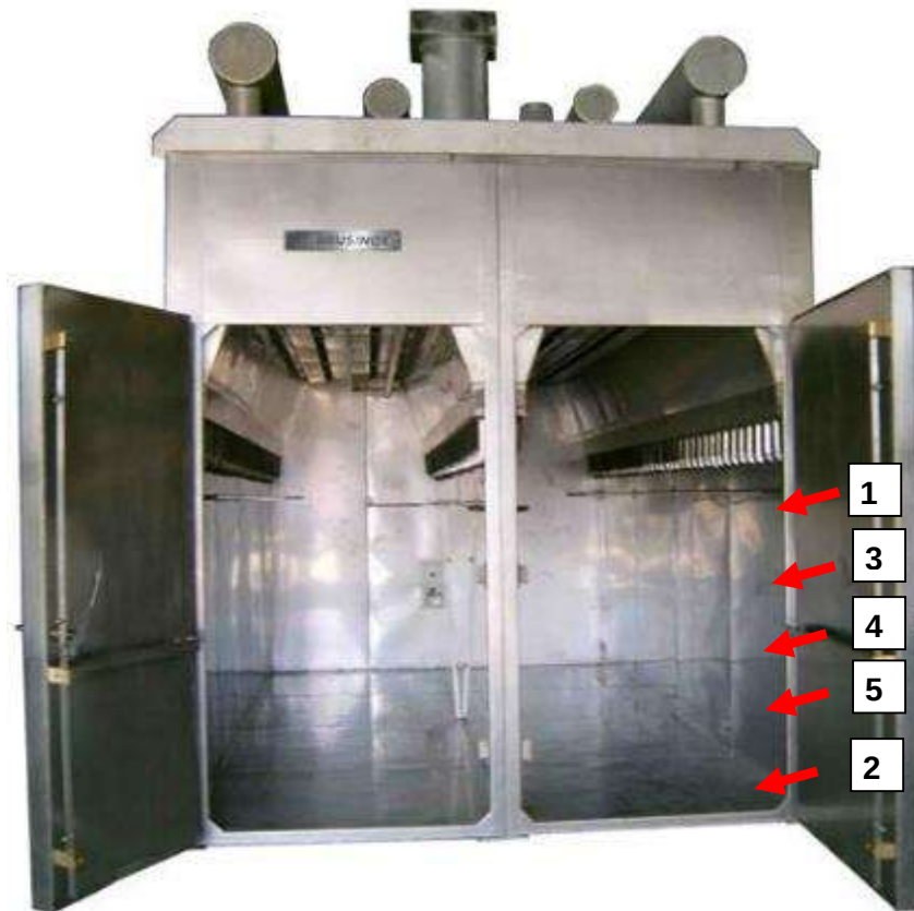
Figura 16. Diagrama esquemático das medidas de velocidade do ar na etapa lenta.
