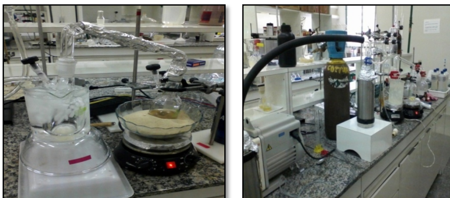
Figura 14. Conjunto destilação (a) e conjunto destilação/bomba de vácuo (b).
