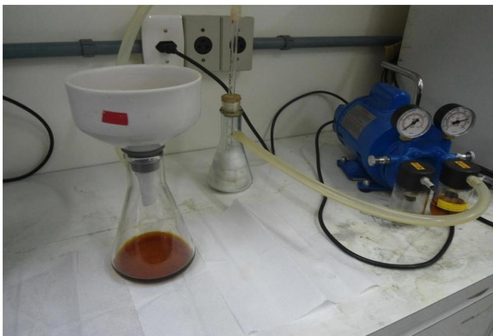
**Figura 10.** Filtragem do óleo de macaúba: resíduo sólido de fibras presente no óleo (à esquerda); óleo do fruto de macaúba obtido após filtragem (à direita).
