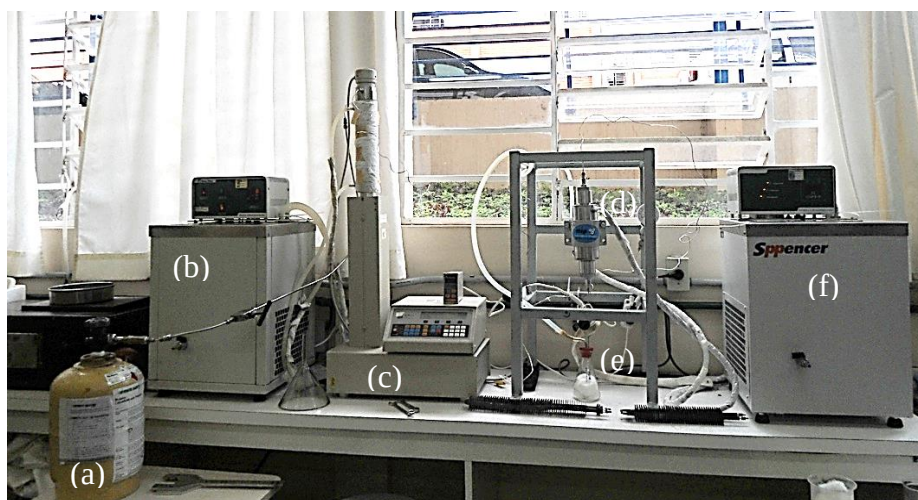
Figura 3 - Vista geral da unidade de extração, sendo: (a) cilindro de n-butano, (b) banho termostático para resfriamento da bomba, (c) bomba seringa, (d) unidade extratora, (e) unidade de amostragem, (f) banho termostático para aquecimento da extratora.
