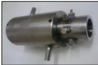
Figura 8 - Célula de equilíbrio de fases com volume variável.
