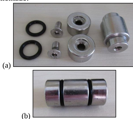
Figura 9 - Pistão móvel. (a) pistão desmontado, com a visualização de todos os componentes; (b) vista lateral do pistão montado.
