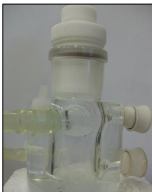
Figura 5 – Célula utilizada para as medidas de solubilidade.
