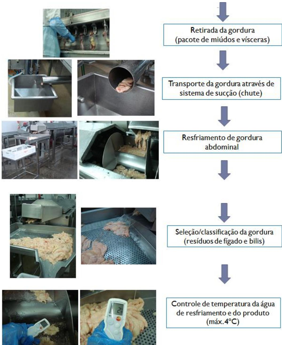
**FIGURA 10** – Esquema simplificado demonstrando o processo de obtenção e produção de gordura abdominal de frango
