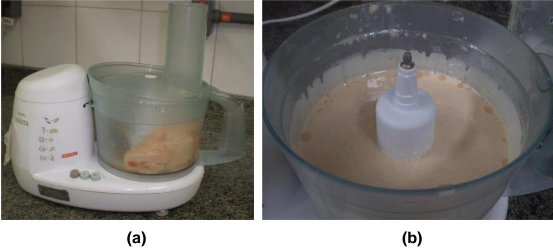
**FIGURA 3** - Preparo das amostras para caracterização: (a) gordura antes da trituração e (b) gordura triturada homogeneizada.
