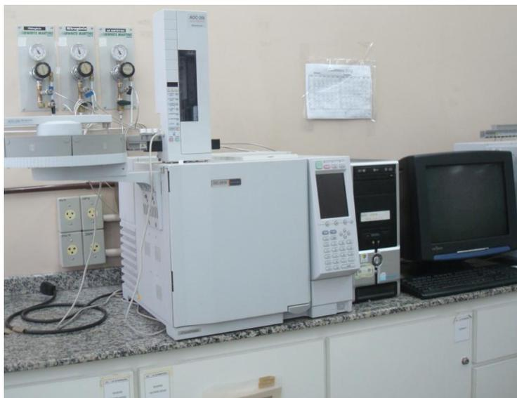
**Figura 7.** Cromatógrafo gasoso utilizado para determinação das conversões em ésteres.
