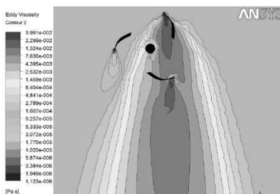
Figura 7 – Energia cinética turbulenta representa a esteira turbulenta sobre Turbina 2.
