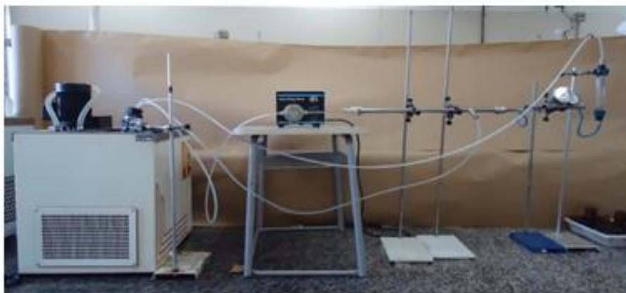
Figura 3.3 - Visão geral da unidade experimental desenvolvida para os ensaios utilizando a membrana fibra oca 50 kDa.
