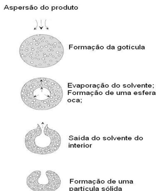
Com a transferência de calor do ar aquecido às gotículas, o líquido da superfície evapora-se rapidamente. As partículas solidificadas geralmente apresentam o mesmo tamanho e forma da gotícula que as originou. Na última etapa, o produto de secagem é transportado por uma corrente de ar sendo posteriormente coletado (BROADHEAD *et al.*, 1992).
