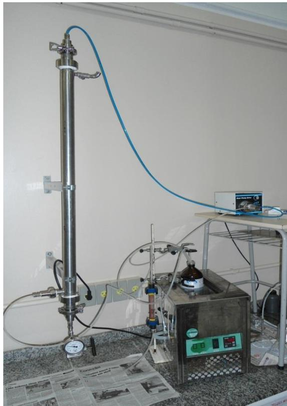
**Figura 7: Vista geral da unidade com módulo membrana de 20 kDa.**
