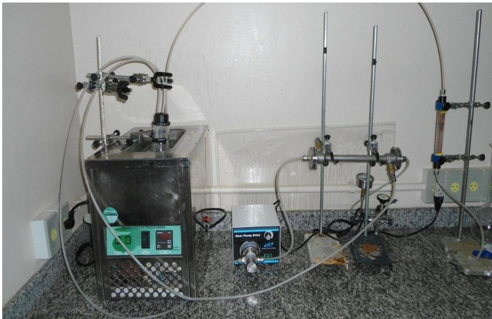
**Figura 8: Vista geral da unidade com módulo para as membrana de 5 e 10 kDa.**
