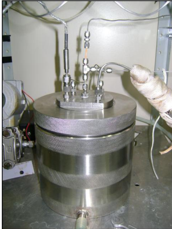
Figura 8 - Câmara de precipitação conectada a todas as linhas da unidade experimental utilizada na co-precipitação da lipase Amano PS em PHBV.
